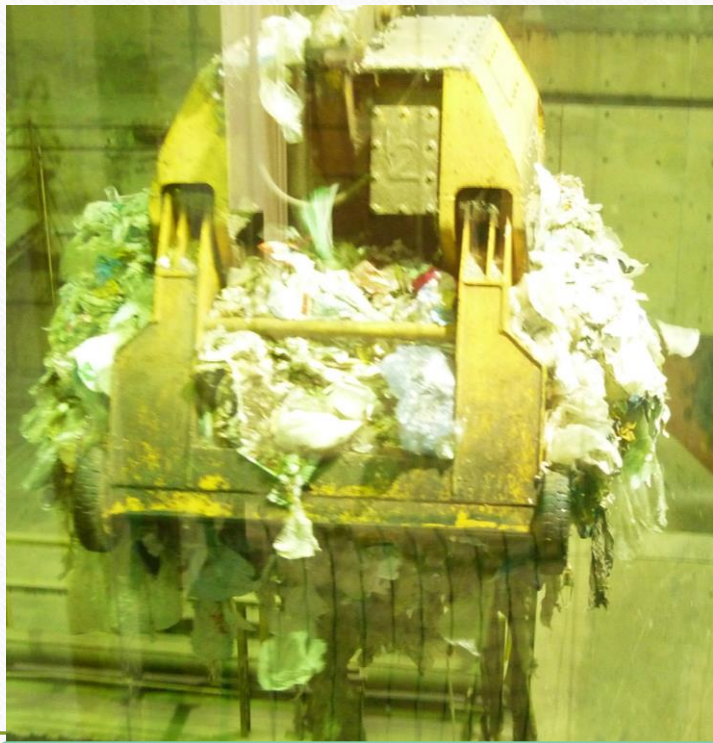
ごみクレーン
